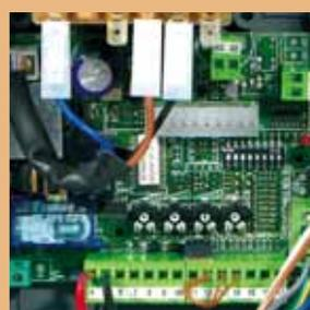
Nouvelle centrale de commande avec borniers extractibles.
